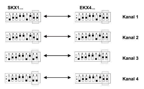
Codierung 1-7 frei wählbar, 1-7 müssen im Sender und im Empfänger gleich sein 8 und 9 im Handsender wie abgebildet einstellen; 8 und 9 im Empfänger auf Position "0" stellen
