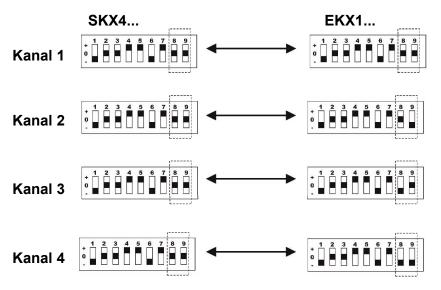
Codierung 1-7 frei wählbar, 1-7 müssen im Sender und im Empfänger gleich sein 8 und 9 im Handsender auf Position "0" stellen; 8 und 9 im Empfänger wie abgebildet einstellen
