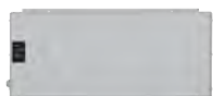
USV-Anlage zur Überbrückung von Spannungsausfällen bis zu 2 Stunden und bis zu 4 Torzyklen, Sicherheitseinrichtungen, Signalleuchten etc. bleiben in Funktion, LED-Zustandsanzeige, automatischer Batterietest, ÜberspannungsfILTER, Schutzart: IP 20 Abmessungen: 560 × 235 × 260 mm (B × H × T),
