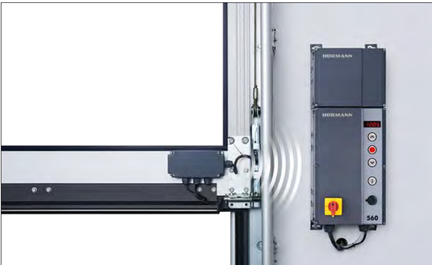
Funkübertragungseinheit zur Übertragung der Signale vom Torblatt zur Steuerung via Bluetooth (keine Wendelleitung), Stromversorgung über eine leistungsstarke Batterie; anschließbare Komponenten: Optosensoren LE (low energy), voreilende Lichtschranke VL1-LE / VL2-LE, 8k2-Leiste, Schlaffseilschalter, Schlupftürkontakt, Nachriegelkontakt
